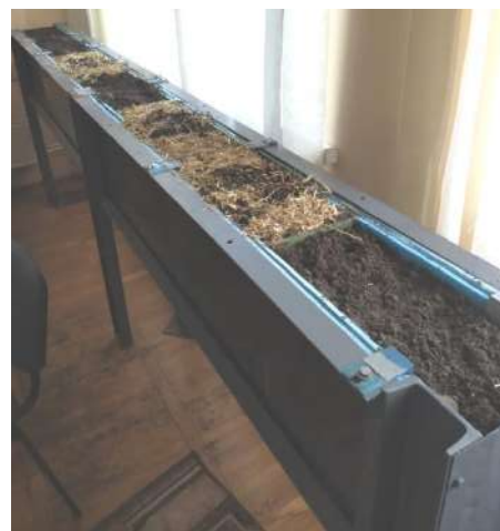
Рис. 1 – Ґрунтовий канал із закладеними зразками ґрунту
