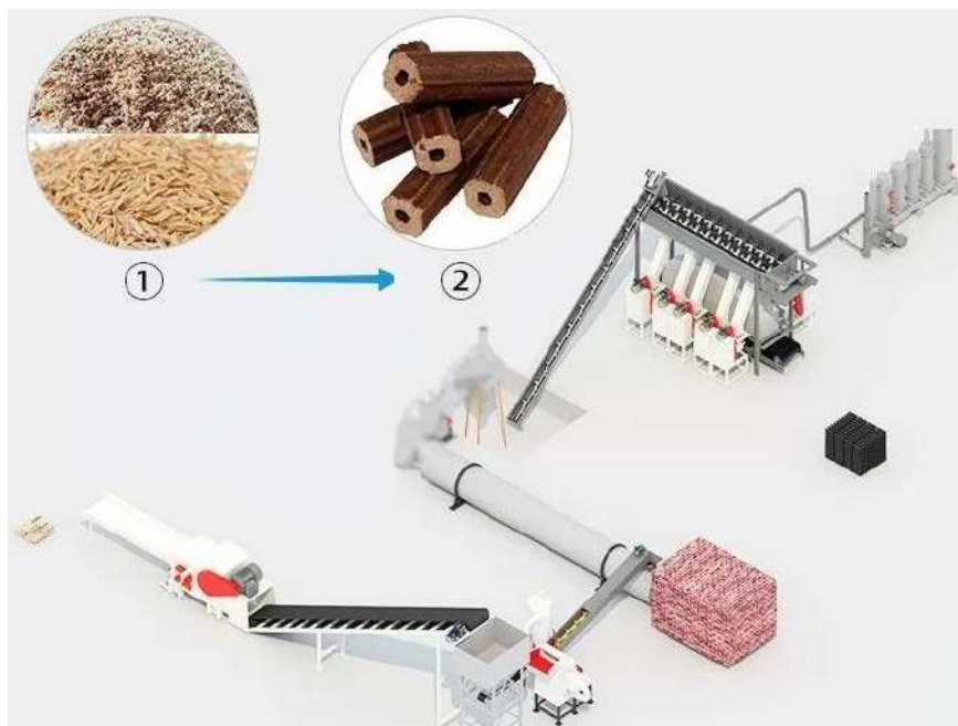
Рис. 5 – Лінія виробництва брикетів типу Pini&Kaу (Shuliy Machinery, n.d.): 1 – сировина; 2 – брикети
