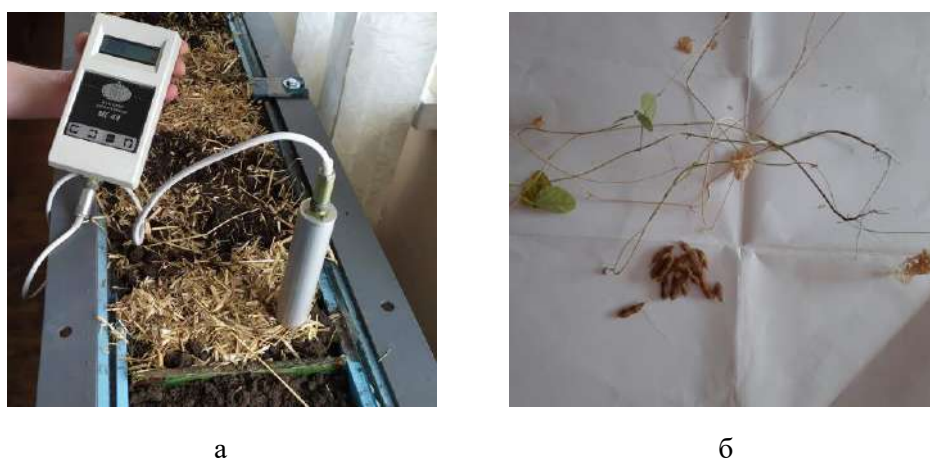
Рис. 3 – Вимірювання вологості ґрунту вологоміром МГ-44 (а) та визначення урожайності сої (б)
