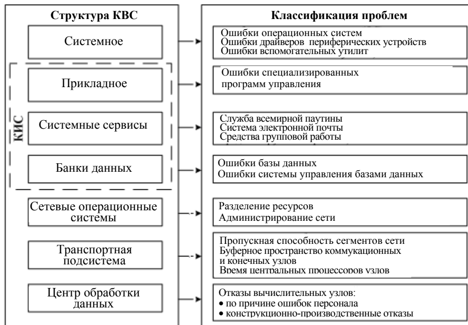
Рис. 1. Структура КВС и классификация проблем по ее уровням
