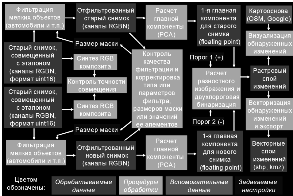
Рис. 3. Основные этапы тематической обработки спутниковых снимков
