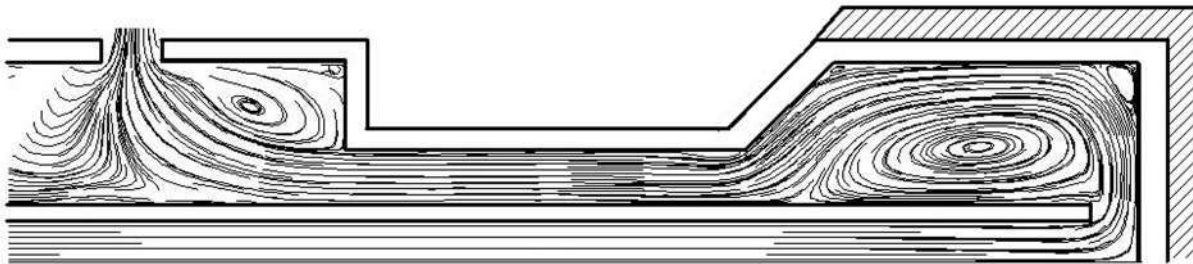
Рис. 2. Картина ліній течії газу в поздовжньому перерізі стабілізатора, що проходить через вісь газоподавальних отворів при обтіканні стабілізатора плоским імпактним струменем
