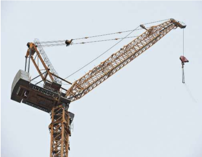
Рис. 5. Башенный кран с подъемной маховой стрелой
