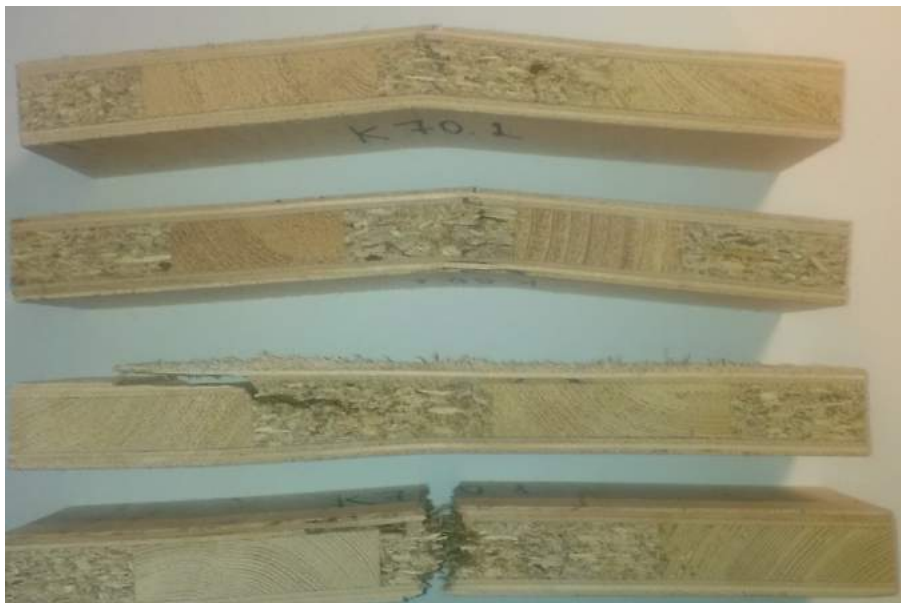
Рис. 17. Зразки комбінованої СП(Брусок-ДСП)ВЖД під навантаженням та в момент руйнування
