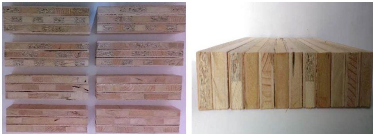
Рис. 6. Загальний вигляд експериментального зразка СП із ВЖД так і ВЖД (ДСП) різних конструкцій для випробування показника міцності під час статичного згину впоперек рейок
