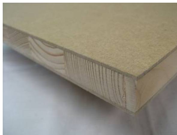
Рис. 1. Тип столярної плити у країнах ЄС Battenboard
