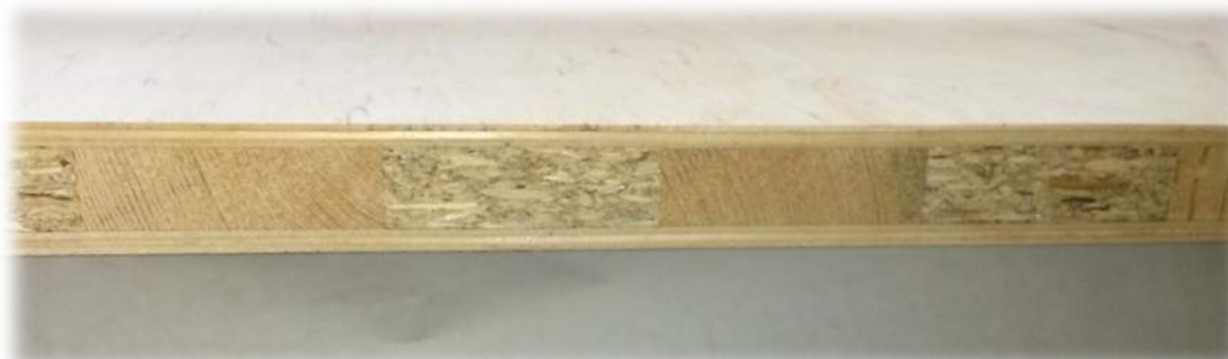
Рис. 11. Другий вид столярної плити із ВЖД (комбінована)
