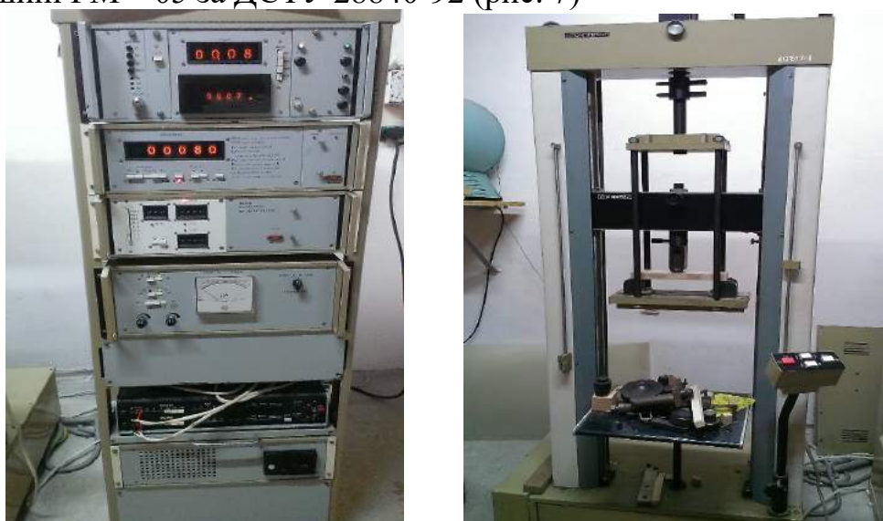
Рис. 7. Випробувальна машина УММ – 5
