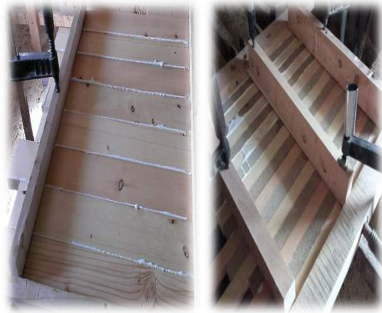
Рис. 12. Процес нанесення клею П-ВА моделі «J-o-w-a-t 1.0.3.0.5» та стикування у приспособленнях
