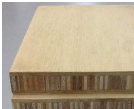
Рис. 3. Тип столярної плити у країнах ЄС Laminboard
