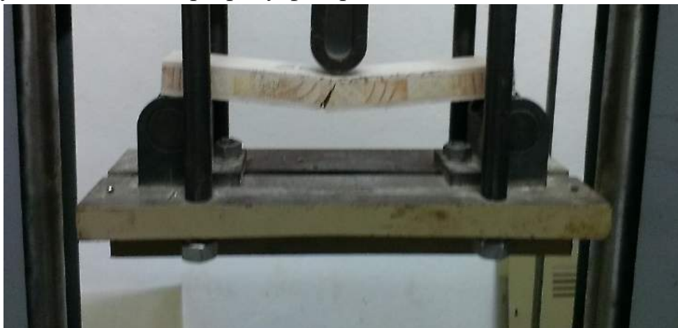
Рис. 18. Взірець личкової фанерою Столярної лабораторної плити з щитом з ВЖД в момент руйнування
