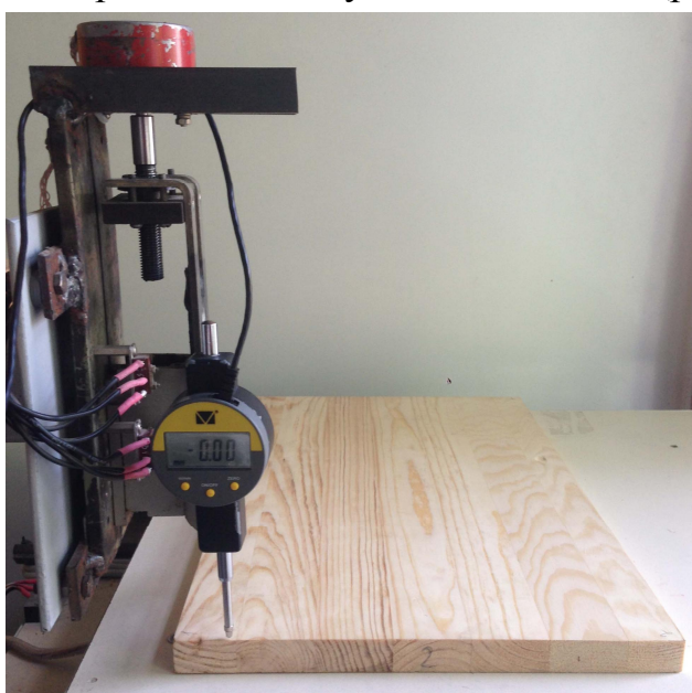
Рис. 2. Експериментальна установка з ЧПУ для визначення формостійкості
