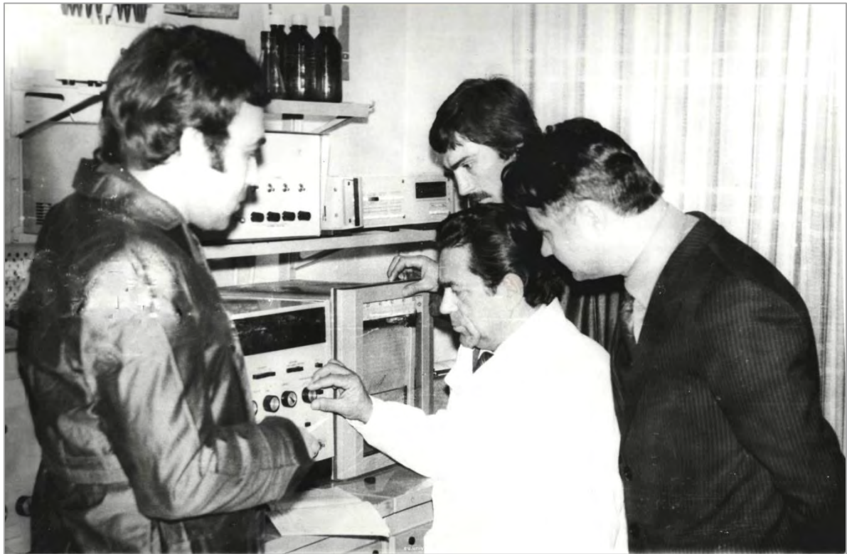
Ф.9. Работа на атомно-абсорбционном спектрофотометре С-112 в проблемной научно-исследовательской лаборатории гидрохимии географического факультета Киевского государственного университета им. Т.Г. Шевченко, (слева): В.К. Хильчевский (младший научный сотрудник), В.И. Пелешенко (заведующий кафедрой гидрологии и гидрохимии), В.И. Осадчий (инженер), Д.В. Закревский (заведующий лабораторией). 1983 г.
