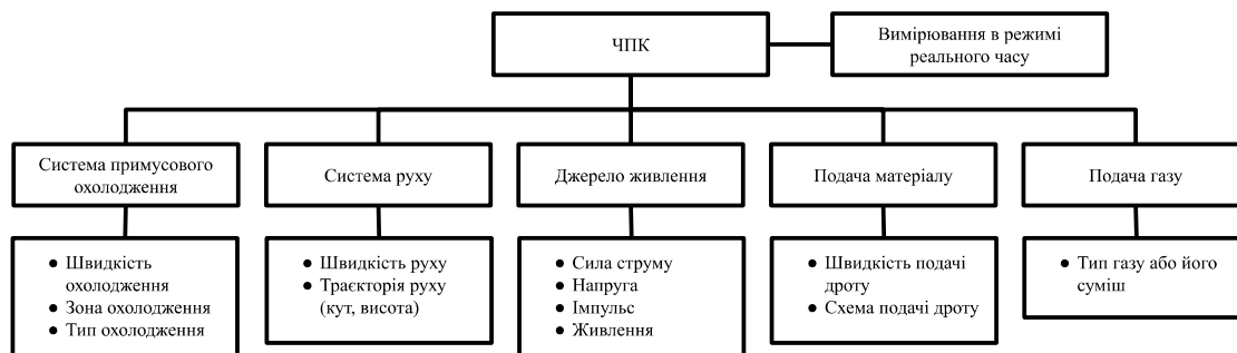
Рисунок 5. Структура та параметри компонентів апаратного забезпечення
