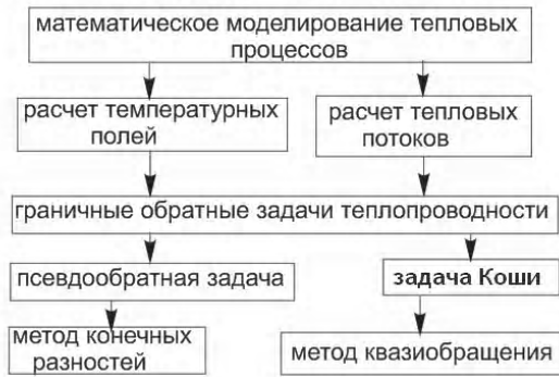
Рисунок 2 – Схема моделирования и идентификации тепловых процессов, протекающих при электроконтактном нагреве
