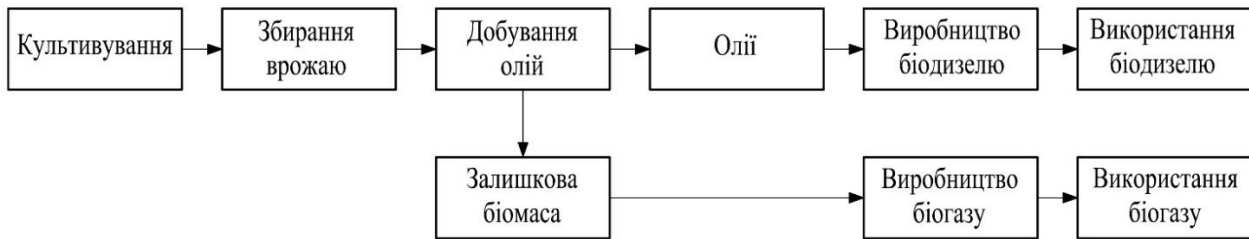
Рисунок 1 – Схема виробництва біопалива з мікроводоростей
