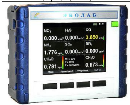
Рис. 5. Загальний вигляд портативного газоаналізатора «Еколаб» для моніторингу.
