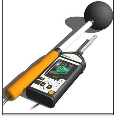
Рис. 4. Загальний вигляд вимірювача параметрів мікроклімату Екотерм-1-DIN та індикаторного блоку Екофізика-D.
