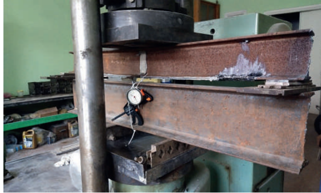
Рисунок 11 — Двотаврова балка, підсилена FRP в пресі після випробування
