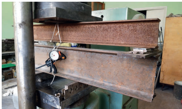
Рисунок 8 — Непідсилена двотаврова балка в пресі перед випробуванням
