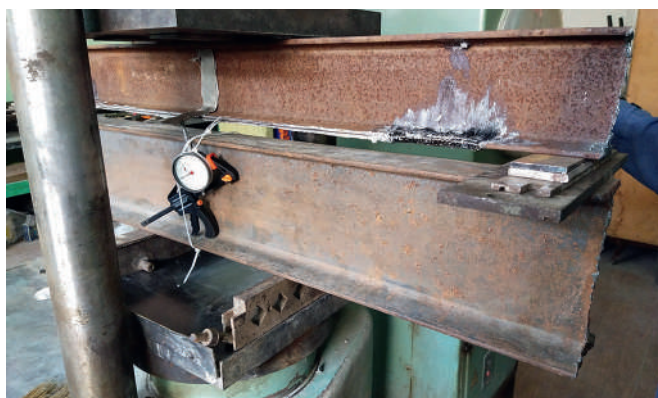
Рисунок 10 — Двотаврова балка, підсилена FRP в пресі перед випробуванням
