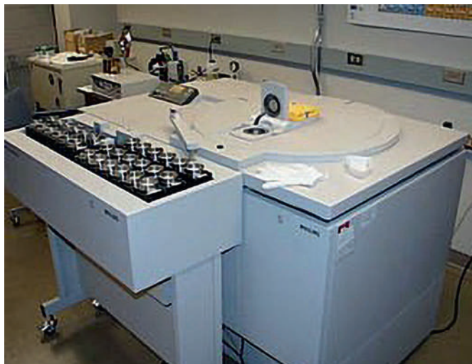
Рисунок 2 — Стационарний рентгенофлуоресцентний аналізатор (X-Ray Fluorescence, XRF)
