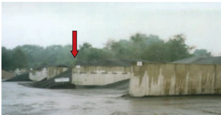
Рисунок 2 — Складування асфальтобетонної крихти на території АБЗ
