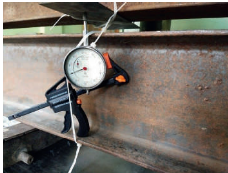
Рисунок 7 — Індикатор годинникового типу, встановлений по середині прогону балки, для вимірювання прогинів
