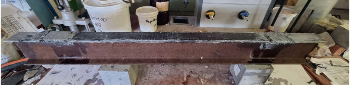
Рисунок 5 — Балка, підсилена зовнішнім армуванням з використанням високоміцних вуглецевих стрічок
