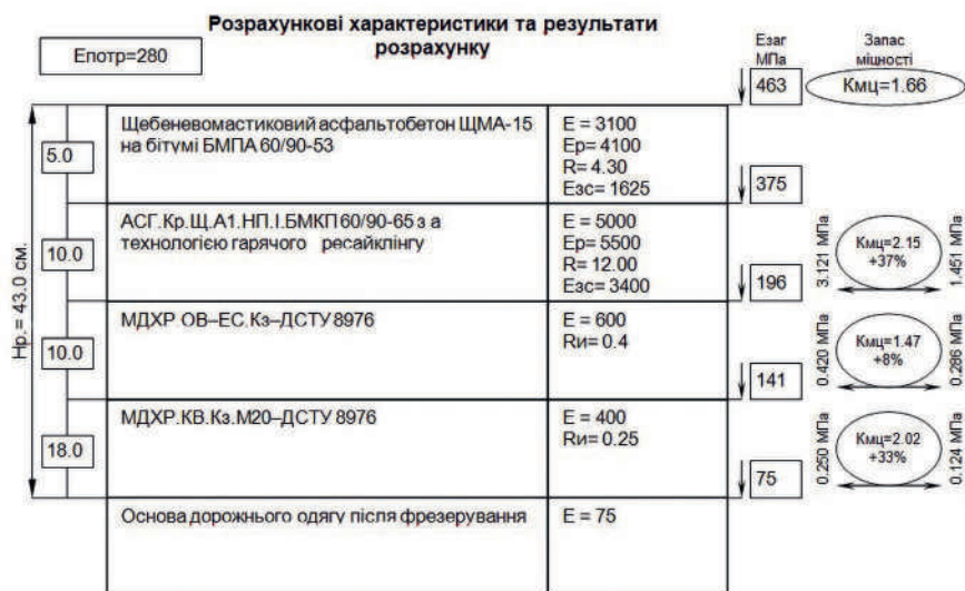
Рисунок 7 — Результати розрахунку конструкції дорожнього одягу (варіант 2)
