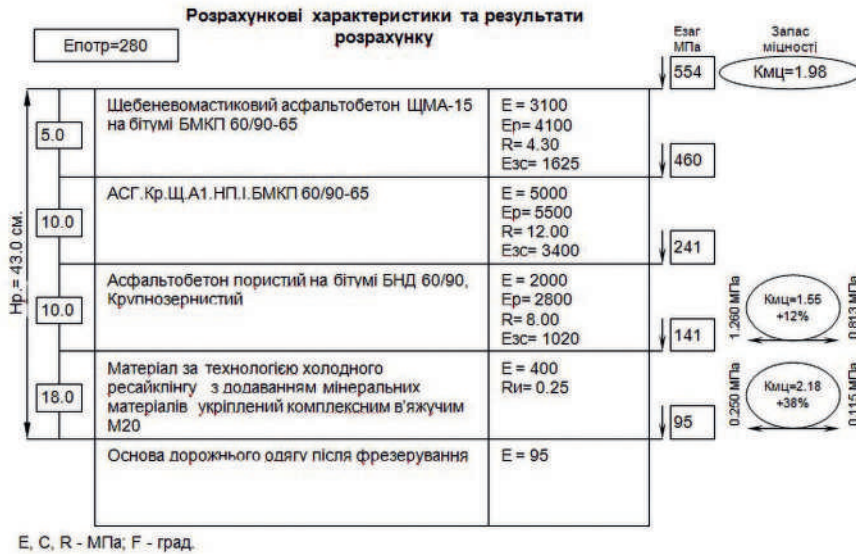
Рисунок 6 — Результати розрахунку конструкції дорожнього одягу (варіант 1)
