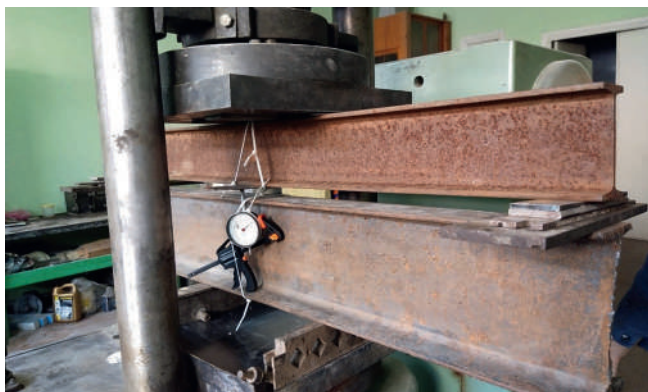
Рисунок 9 — Непідсилена двотаврова балка після випробування
