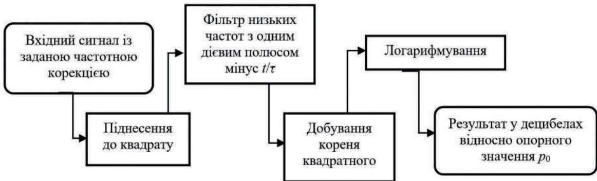
Рисунок 1 — Послідовність обробки сигналу при формуванні показників рівня звуку з часовою корекцією
