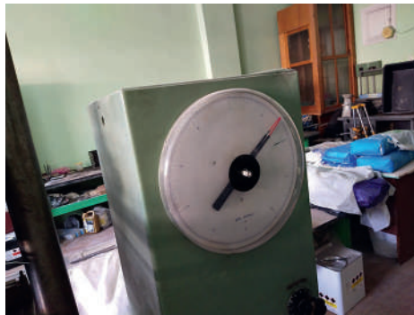
Рисунок 6 — Прес (50 кН) для прикладання навантаження при проведенні випробувань
