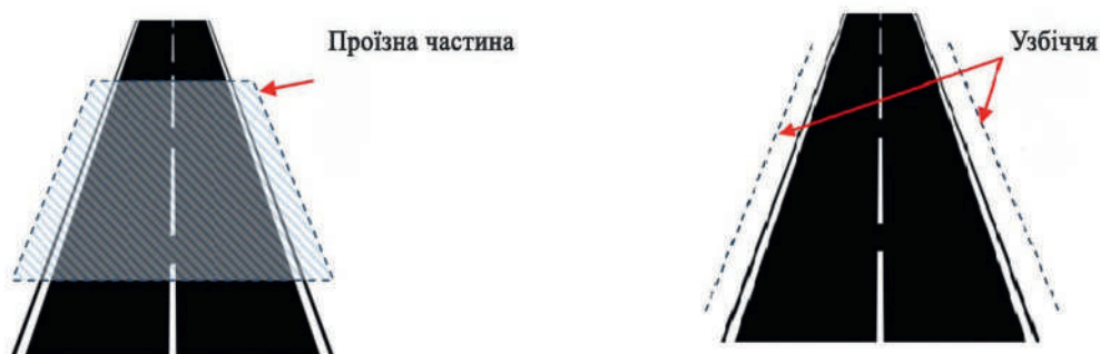
Рисунок 1 — Типи систем виявлення тварин на автомобільних дорогах
