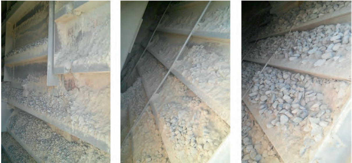
Рисунок 3 — Фракційна сегрегація в гарячих бункерах асфальтобетонного заводу
