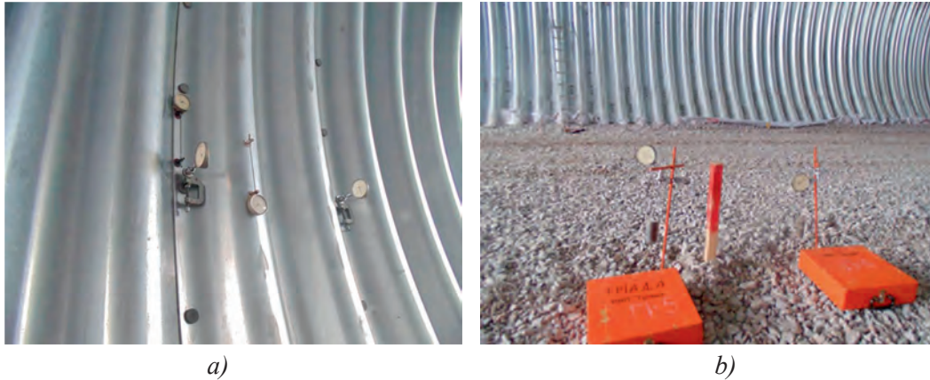
Рисунок 7 — Розміщення вимірювальних приладів на металевій гофрованій конструкції: а) прогиномірів П-1, П-2 та ПТГ І-1 та І-2; б) прогиномірів П-5, П-6
