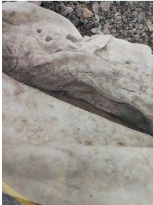
Рисунок 8 — Стан ГСМ після проведення експериментальних досліджень в конструкції ПДМЗ № 2
