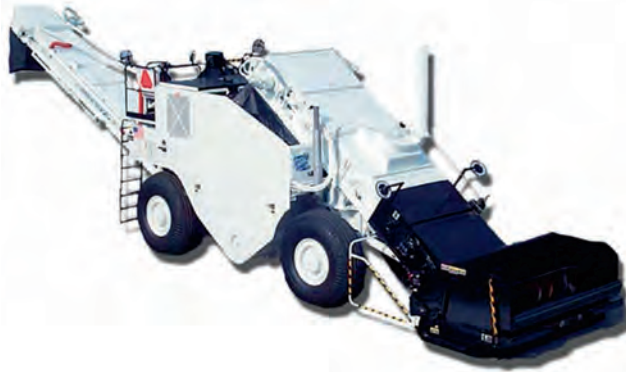
Рисунок 7 — Типовий мобільний перевантажувач
