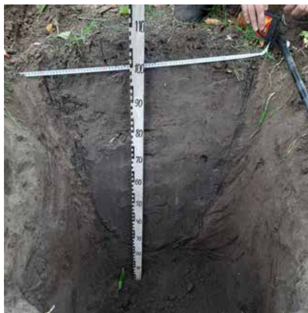
Рис. 1. Динаміка фактичного контуру зони зволоження ґрунту у насадженнях черешні за РПВГ 70 % НВ і за розрахункового шару 0,6 м
