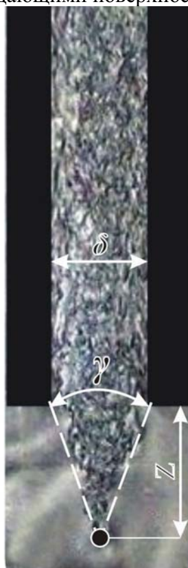
Рис. 2 Визуализация течения газожидкостной струи в зазоре между теплоотдающими поверхностями
