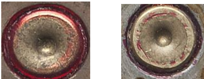
Рис. 4. Сліди бійка на капсулях гільз, утворені ударниками зброї промислового виготовлення.
