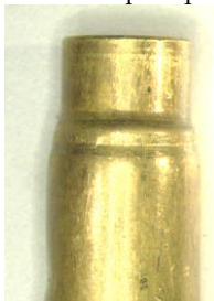
Рис. 10. Сліди роздуття дульця гільзи патрона, відстріляного з відновленого макету масо-габаритного автомата Калашникова з саморобним стволом.
