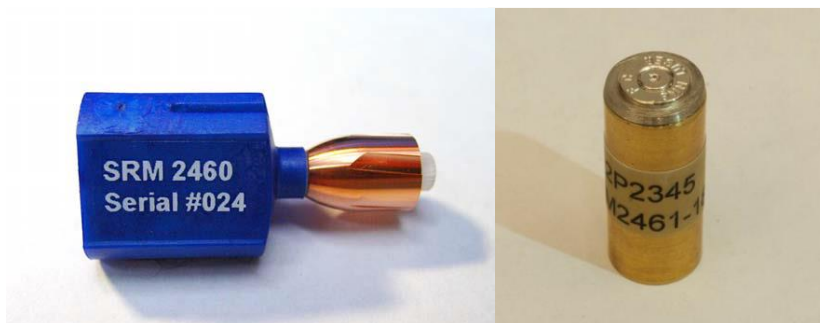
Рис. 2. Стандартна куля NIST SRM 2460, установа на синій заглушці (ліворуч) та прототип стандартної гільзи SRM 2461 (праворуч) (Національний інститут стандартів і технологій США).
