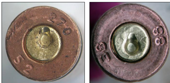
Рис. 12. Сліди на донних частинах гільз патрона 7,62x25 мм, стріляного з пістолета ТТ.
