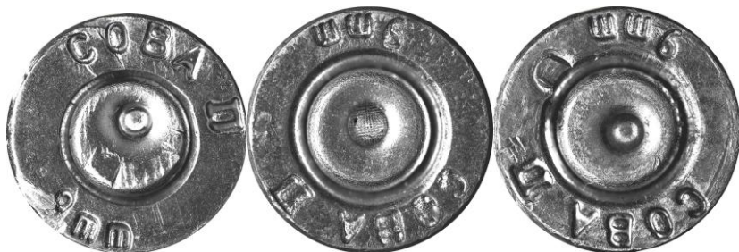
Рис. 18. Зображення криміналістичної мітки на слідосприймальній поверхні гільзи, стріляної з пістолета «ЕРМА-Z85Т» (ліворуч); на слідосприймальній поверхні гільзи, стріляної з пістолета «Беркут – Streamer» (в центрі); на слідосприймальній поверхні гільзи, стріляної з пістолета «ПМР-УОС» (праворуч).
