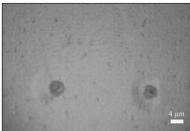
Рис. 4. Оптична мікрофотографія поверхні досліджуваного зразка. Дві концентричні плями – типові сліди дії лазерного променя потужністю 10 мВт
