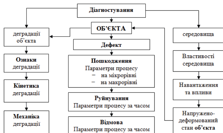
Рис. 1. Структура процесу діагностування технічного стану ОБ
