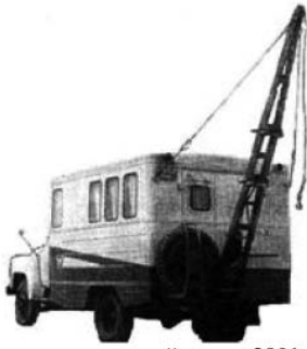
Рис. 13 Автопересувна майстерня 3901, головним конструктором якої був Ю.Репман виготовлено Ковельським механічним заводом (1965-1967 рр.)
