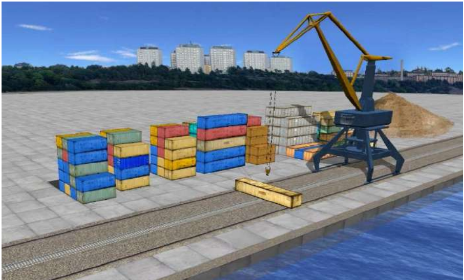
Рисунок 2 – Імітаційна трьох мірна модель портального крана
