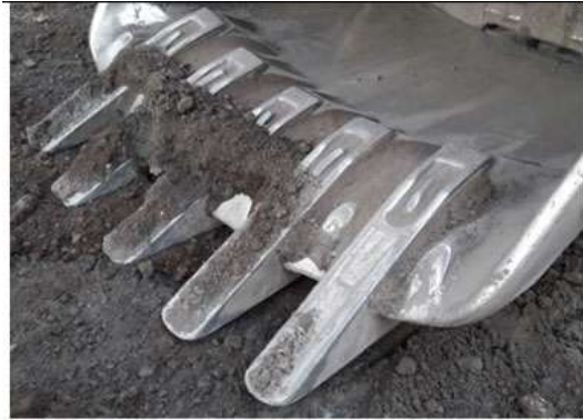
Рисунок 1 – Ківш екскаватора ЕКГ-5
