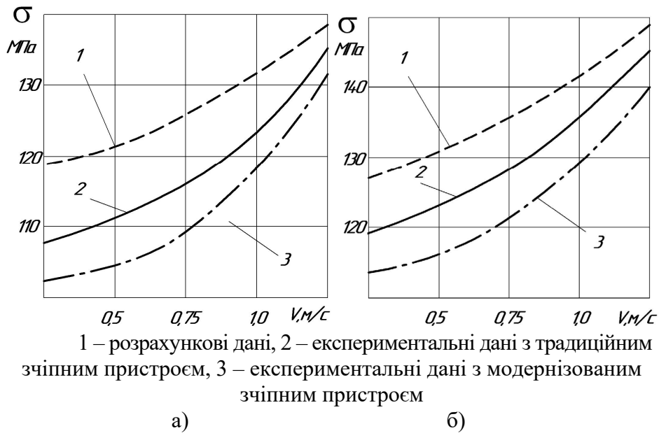
Рисунок 3 – Навантаження в подовжній балці тягової рами: а) в штовхаючому режимі, б) в тяговому режимі
