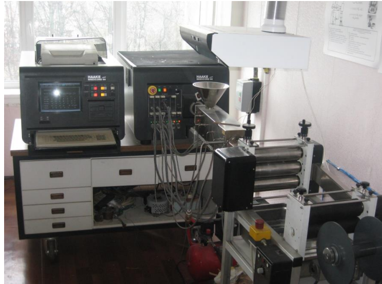
Рисунок 4 - Компьютеризированный экструзиограф «Rheocord 90» фирмы «HAAKE» (ФРГ)
