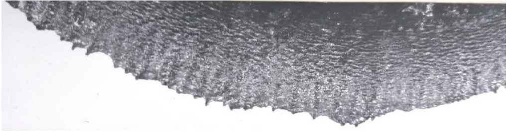
Рис. 6. Кромка гарнісажу при відцентровому розпиленні: поперечні та поздовжні хвилі в рідкому металі
