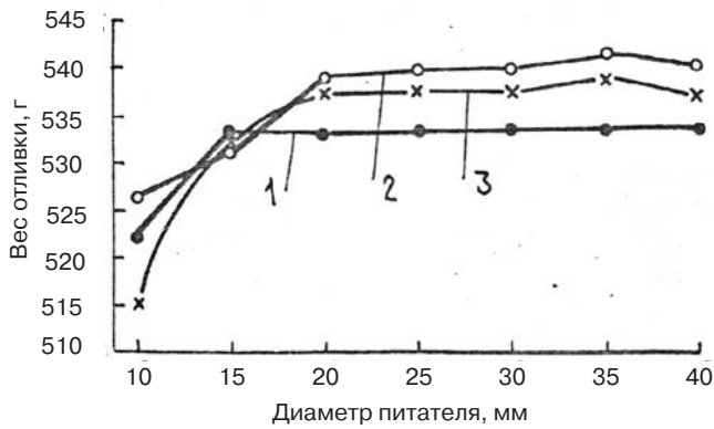
Рис. 7. Зависимость веса кокильной части отливки от диаметра песчаного питателя: 1 – Al; 2 – Al+6%Si; 3 – Al+11,5%Si
