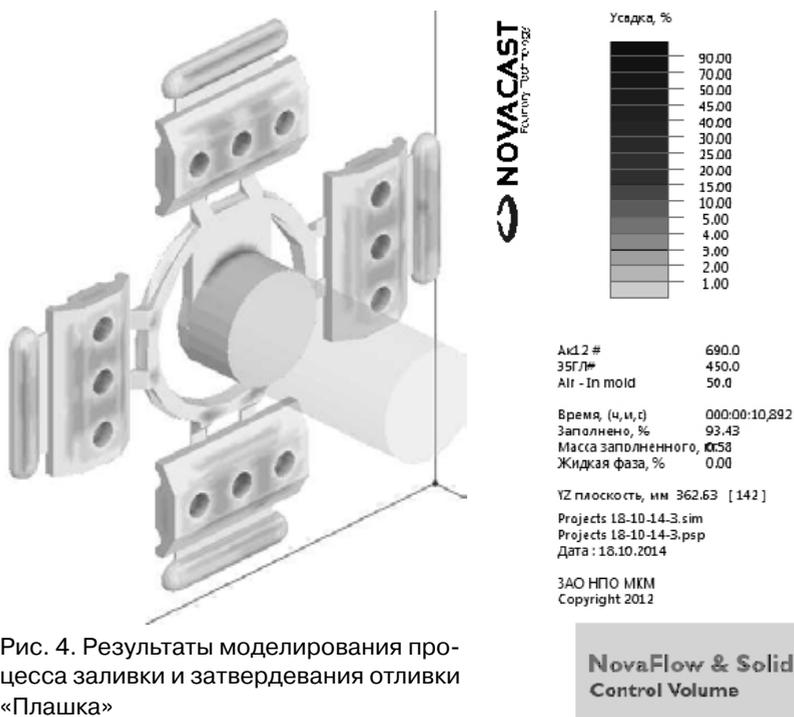
Рис. 4. Результаты моделирования процесса заливки и затвердевания отливки «Плашка»
