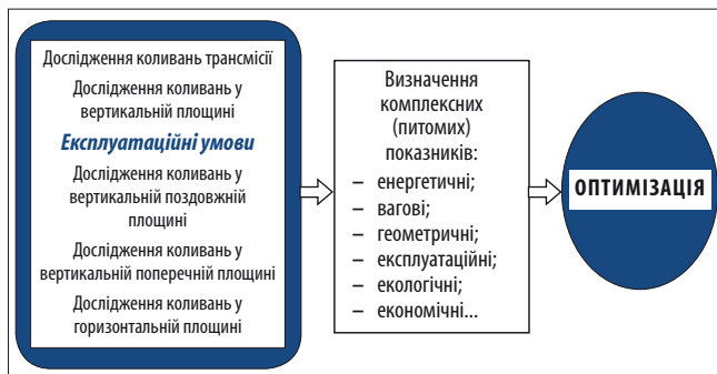
Рис. 3. Схема процедури обґрунтування параметрів лісових машин
