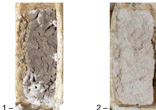
Рис. 2. Саморассыпание спека. Температура спекания 1300°C, охлаждение в печи до 1200°C: 1 – спек из печи; 2 – спек после охлаждения до комнатной температуры
