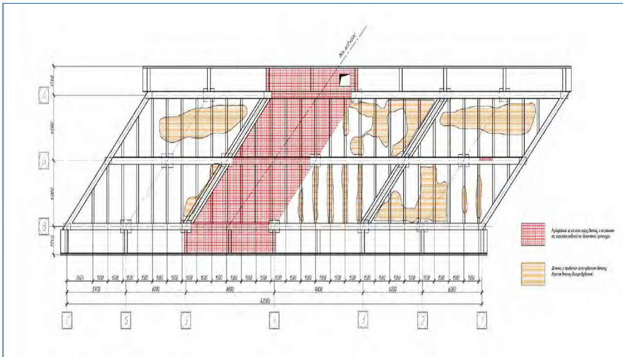
Рис. 5. План-схема дефектів несучих балок та плити шляхопроводу
