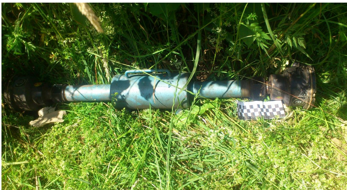
Рисунок 1.22 – Радіоізотопний сигналізатор рівня, виявлений на території
