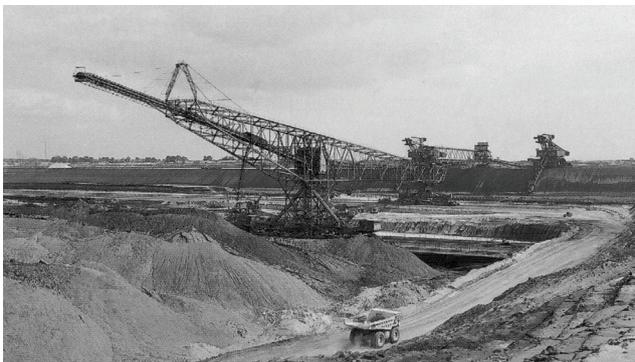
**Рис. 5.34. Транспортно-отвальный мост на угольном карьере (ФРГ)**
