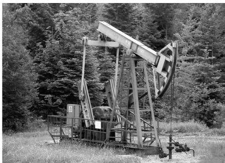
**Рис. 6.11. Общий вид скважины, оборудованной для насосной добычи нефти**
