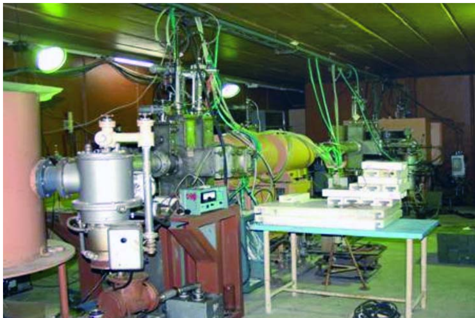
Рис. 3. Экспериментальная установка для исследования ядерных реакций на циклотроне У-240. Институт ядерных исследований НАН Украины
