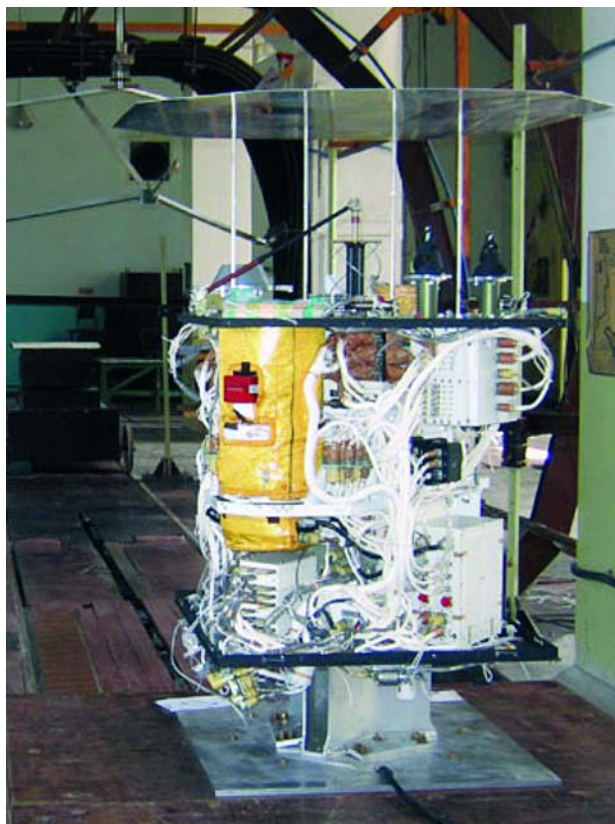
Рис. 10. Определение магнитных параметров космического аппарата "EgipSat-1" на Магнетодинамическом комплексе НТЦ МТО НАН Украины
