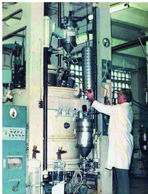
Установка для выращивания крупногабаритных монокристаллов
