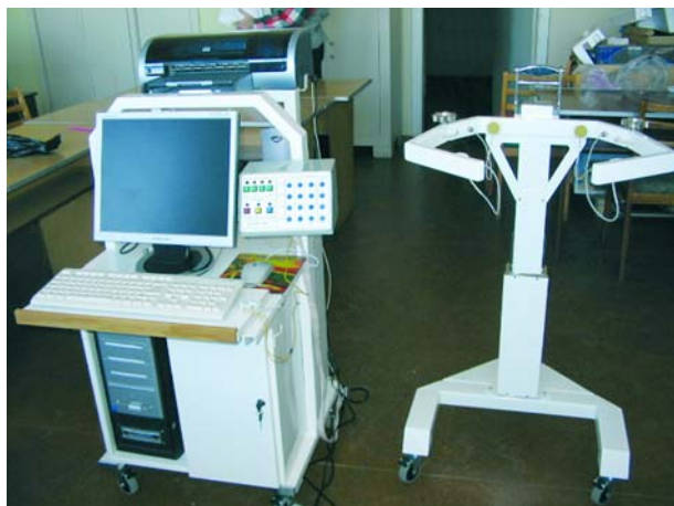
Рис. 4. На основе фундаментальных исследований генерирования и распространения звука в сложных неоднородных средах разработан, создан и сертифицирован экологически безопасный “Фоноспирографический компьютерный комплекс КоРА-ОЗМ1”, предназначенный для диагностики и мониторинга бронхо-легочных заболеваний человека
