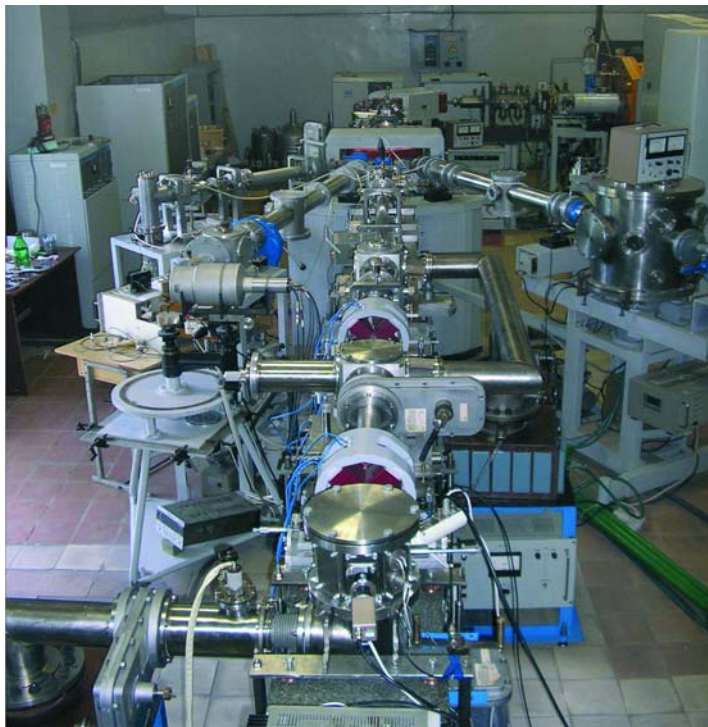
Рис. 4. Ядерный сканирующий микронд на основе электростатического ускорителя
