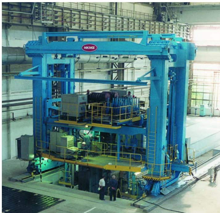
Установка для электрошлаковой сварки металла боль- шой толщины (до 4 м)
