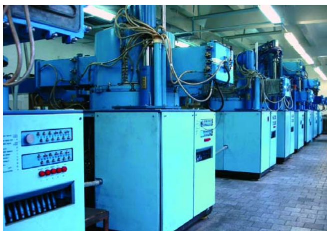
Участок опытного производства сапфира методом горизонтально направленной кристаллизации
