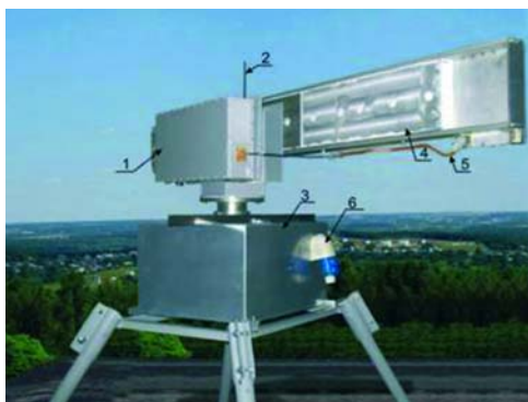
Радиолокационная система миллиметрового диапазона нового типа для наблюдения за объектами и их движением на территориях аэропортов
