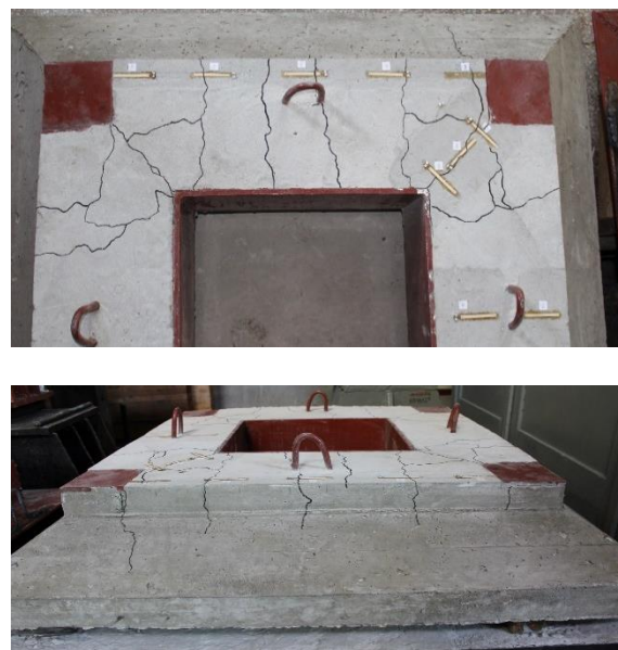
Рис. 6. Розподіл тріщин на верхній розтягнутій поверхні зразка серії ПМК
