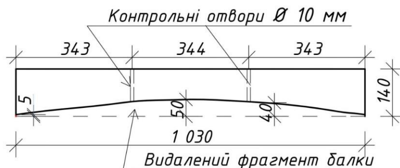
Рис. 3 Конструкція зразків, підготовлених до ремонту
