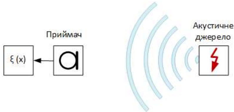
Рисунок 10 – Найпростіша модель системи реєстрації акустичних коливань
