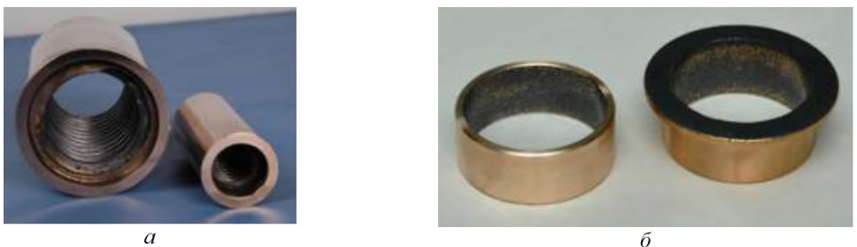
Рисунок 13 – Заготовки гайок (а) та втулки (б) без фланцю (зліва) і з фланцем (справа) з матеріалу БФГ-50М
