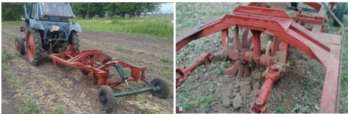
Рисунок 10 – Експериментальні дослідження установки з новими робочими органами в агрегаті з трактором МТЗ-80
