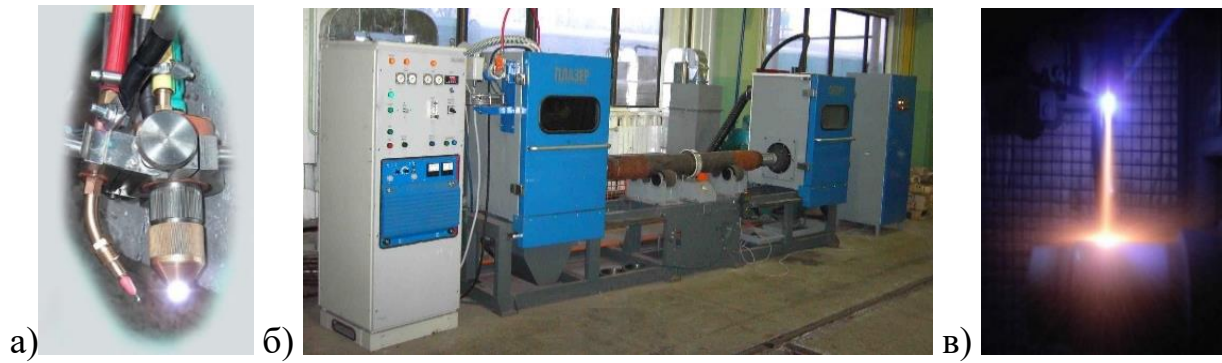
Рисунок 12 Зовнішній вигляд промислового плазмотрону (а) та напівавтоматичної лінії (б) і процесу плазмо-дугового напилювання покриттів на деталі типу «вал» рухомого складу залізничного транспорту.
