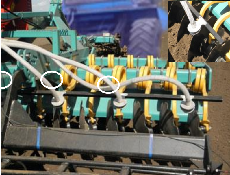
Рис. 11. Установка тарілчастого розсіювача на дисковому агрегатів під час польових досліджень
