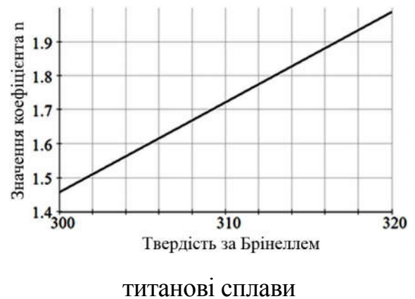
Рисунок 4 – Графік залежності коефіцієнта n від твердості стружки
