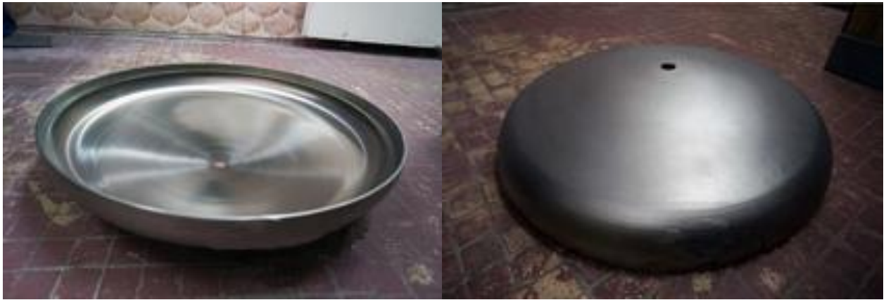
Рис. 10 – Етапи формоутворення деталі «днище» ресивера способом поетапного розтягнення фланця: а – проміжна стадія витягування; б – готова деталь
