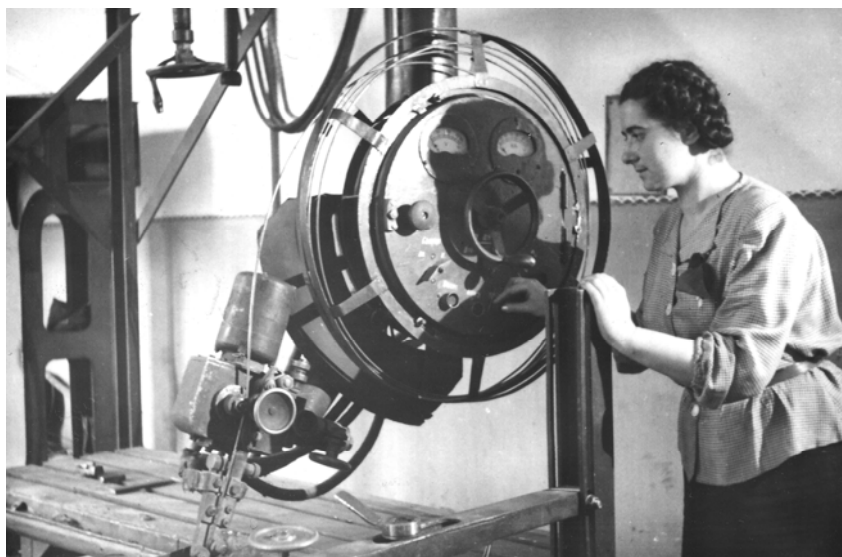
Л. М. Гутман, молодший науковий співробітник Інституту електрозварювання ім. С. О. Патона АН УРСР в лабораторії технологічного зварювання за наплавленням замків бурильних труб для нафтопромисловості. Київ, 1946.
